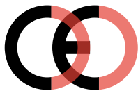
Falsche CE-Kennzeichnung (zu dicht)
